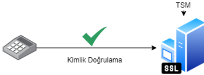
Şekil 6: GİB-BİM'in kimliğinin SSL sertifikası ile doğrulanması
